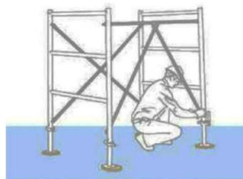
◆ An den Längsseiten eine Diagonale und eine K-Diagonale anbringen, Sicherung der Fußspindeln dabei mit befestigen.
